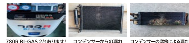
780R BI-GAS 2台あります! コンデンサーからの漏れ コンデンサーの腐食による漏れ
